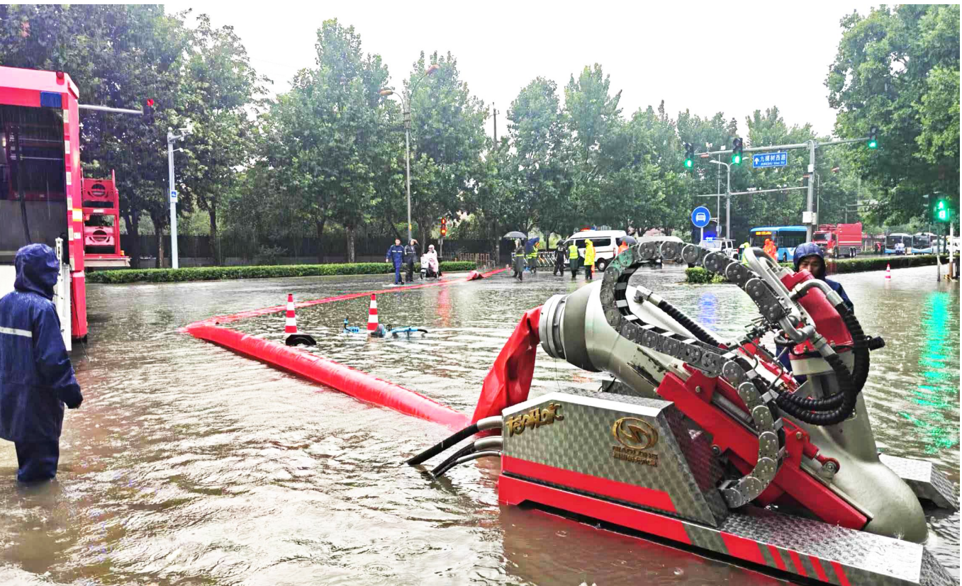
暴雨致道路积水,通州消防启用“龙吸水”战车紧急开展排涝作业。(通州消防供图)
