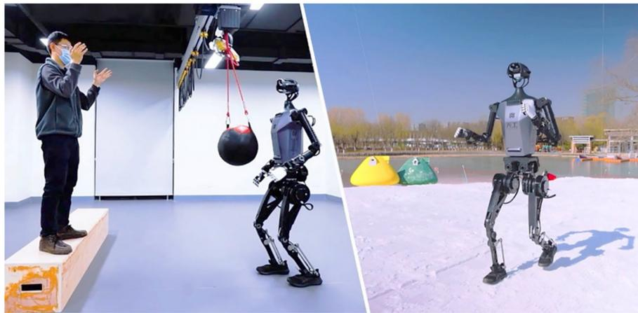
“天工”机器人平衡能力极强，可抵抗强大冲击，也能在雪中如履平地。
