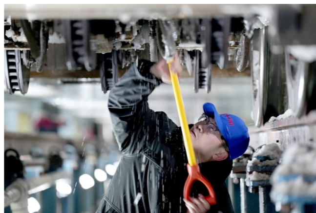
工作人员正在进行打冰作业，保障旅客平安回家。鲁静/摄
