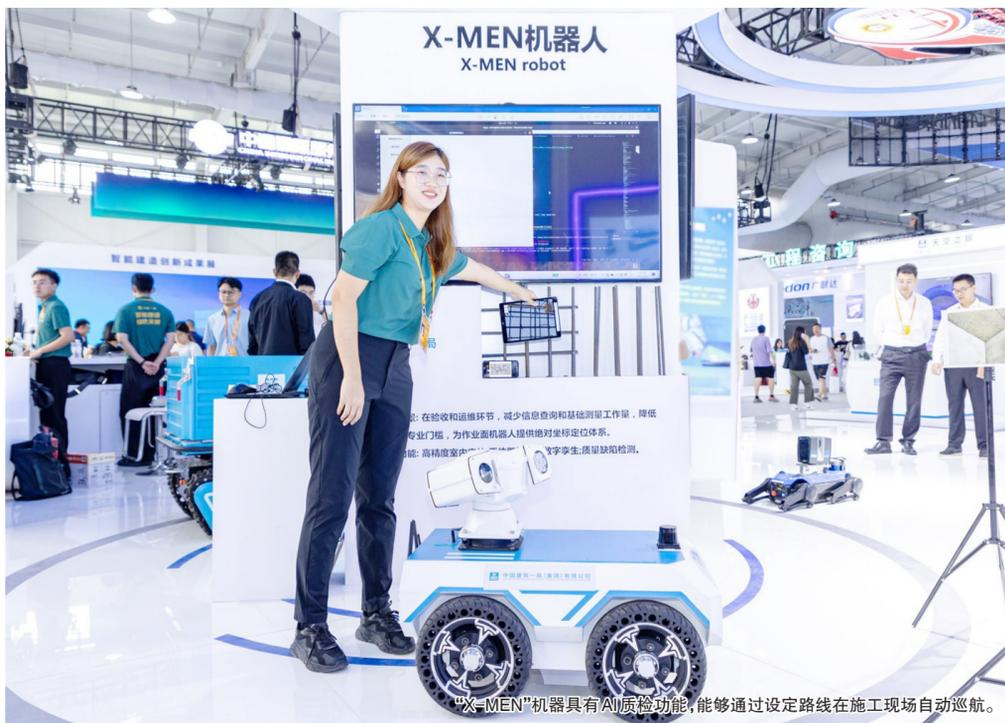
“X-MEN”机器人具有AI质检功能，能够通过设定路线在施工现场自动巡检。
