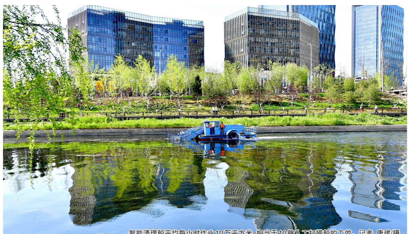
智能清理船平均每小时作业10万平方米,相当于10艘人工打捞船的工效。记者 唐建/摄
