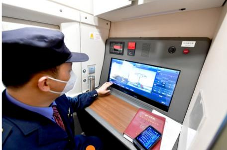
列车运行状况不仅可以在触摸屏上显示，也可将所有数据实时发送到随车机械师的手持终端上。
