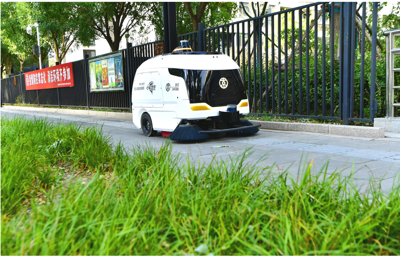
无人驾驶清扫车沿步行道缓缓前行，将落叶和垃圾清扫进机身内部的垃圾箱。记者 唐建/摄
