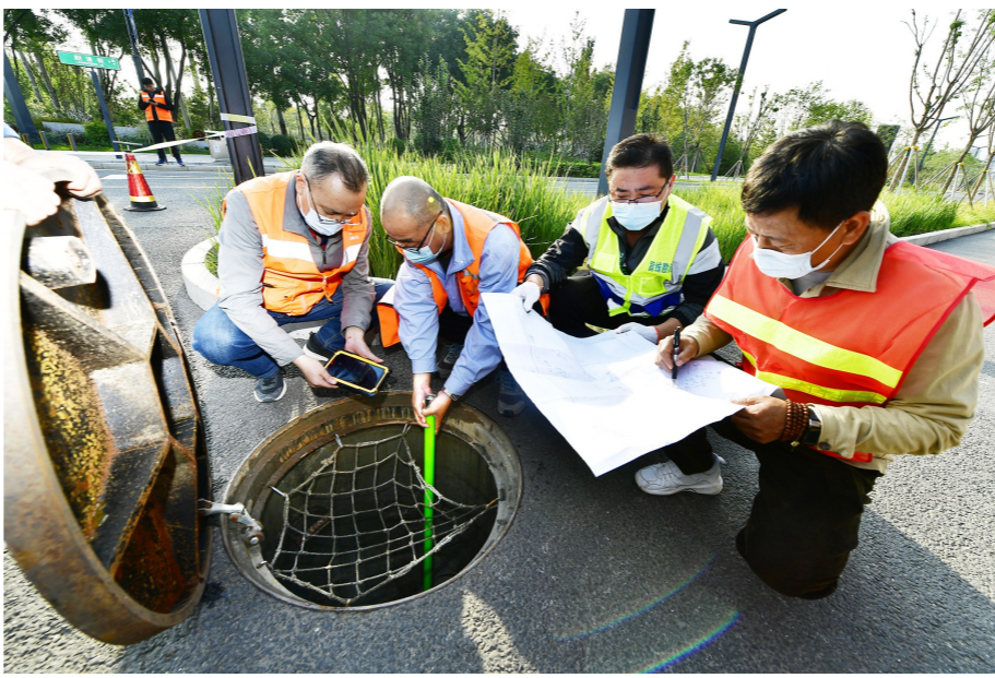
测量数据处理后形成三维模型,可为全区地下管线安全防护工作提供数据支持服务。记者 唐建/摄
