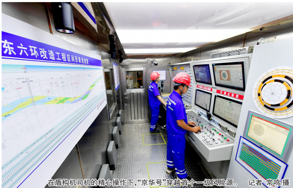
在盾构机司机的精心操作下,“京华号”穿越首个一级风险源。 记者 常鸣摄
