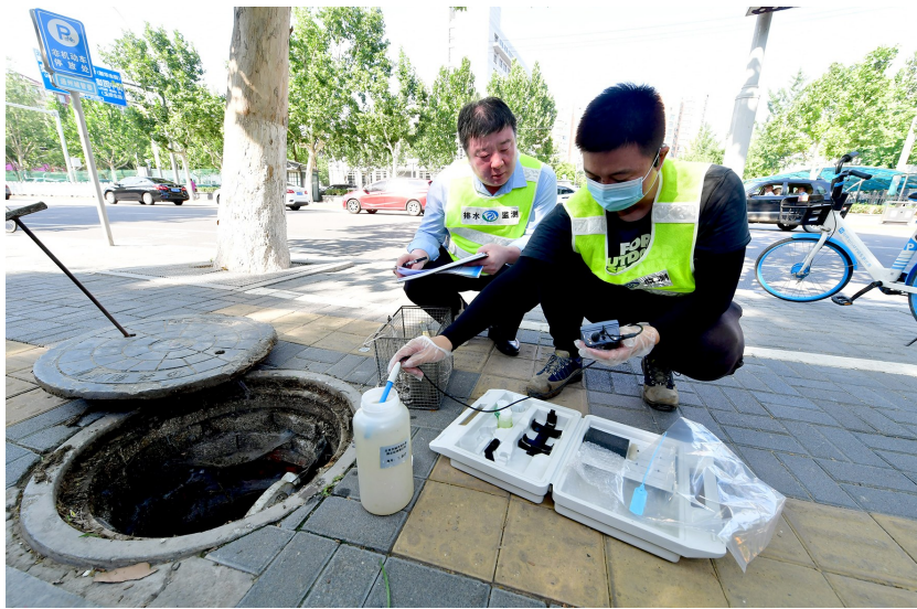
执法人员抽取污水水样,检测附近餐馆是否向管网超标排放污水。记者 常鸣/摄
