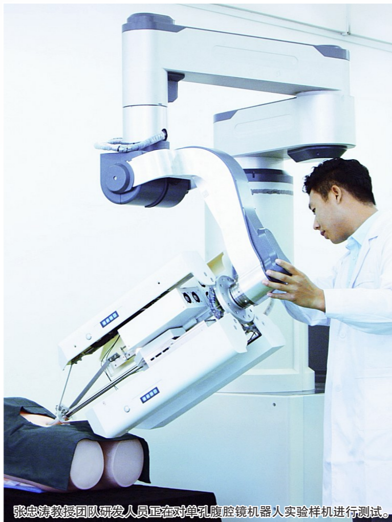
张忠涛教授团队研发人员正在对单孔腹腔镜机器人实验样机进行测试。
