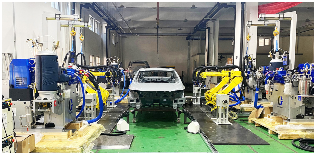
兴信易成实验室内，正在进行汽车生产线涂胶机器人的集成预组装。搬到燕郊后，企业有了可以“伸展拳脚”的新厂区。
