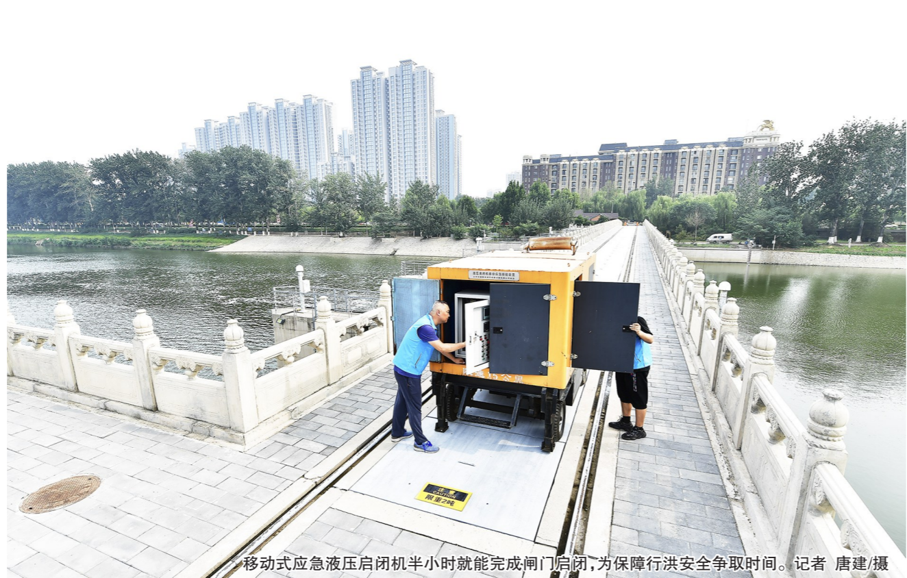
移动式应急液压启闭机半小时就能完成闸门启闭,为保障行洪安全争取时间。记者 唐建/摄
